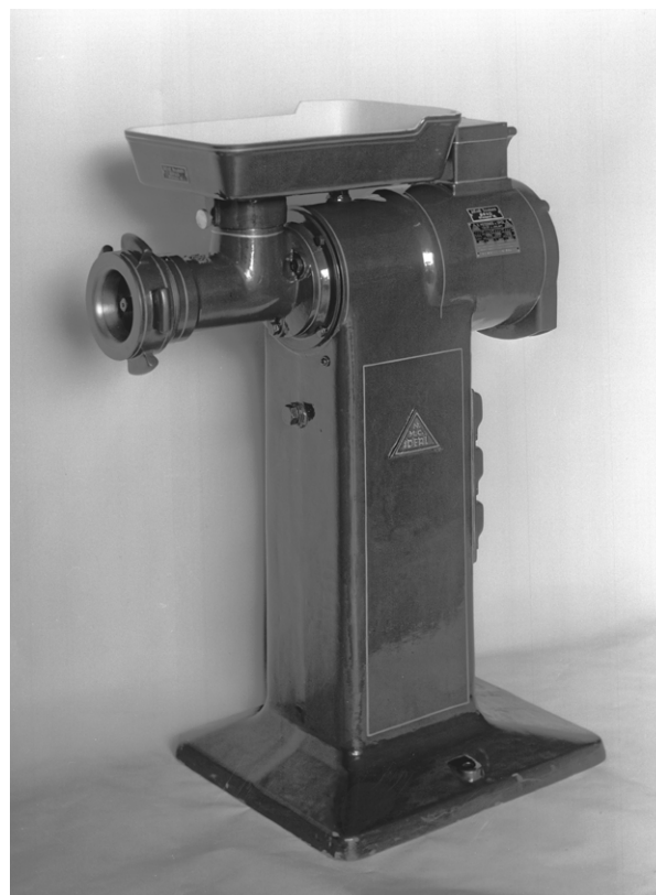
Obr. 28/ Řezačka s elektromotorem. Zhotovila strojírenská firma Alfred Neumann, Brno, Křenová 16. Asi 40. léta 20. stol. Fotosběrka TMB, 20.3-2213.
