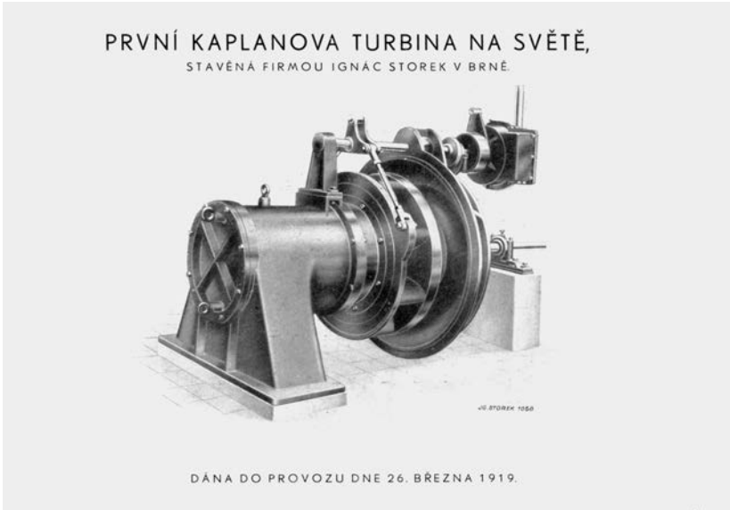
Obr. 5 První Kaplanova turbína, instalovaná ve Velmu v roce 1919, v katalogu firmy Storek. TMB, PP Viktora Kaplana, kart. 32, i. č. 12.00-3464.
