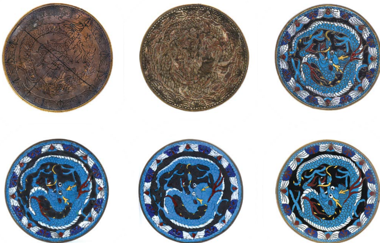
Fáze výzdoby technikou přihrádkového emailu (cloisonné) na příkladu orientálních podšálků ze sbírky Moravské galerie v Brně, inv. č. U 5914
