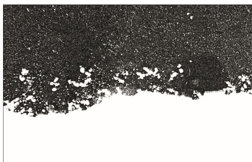
002 Fázové rozhraní s adhezní mezivrstvou kov – smalt, zvětšení 500 × Podjuklová a kol. 2010. Phase interface with adhesion interlayer metal – enamel 500x magnification.
