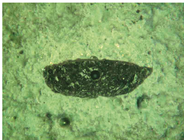
003 Vada smaltového povlaku „rybí šupina“ , Podjuklová a kol. 2010. Crack of enamel coating „fish scales“ .
